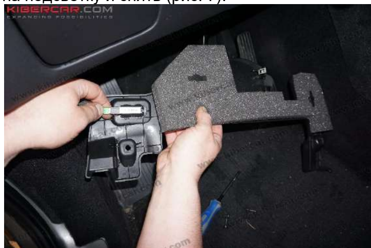
Рисунок 7 – Демонтаж накладки под рулем автомобиля
