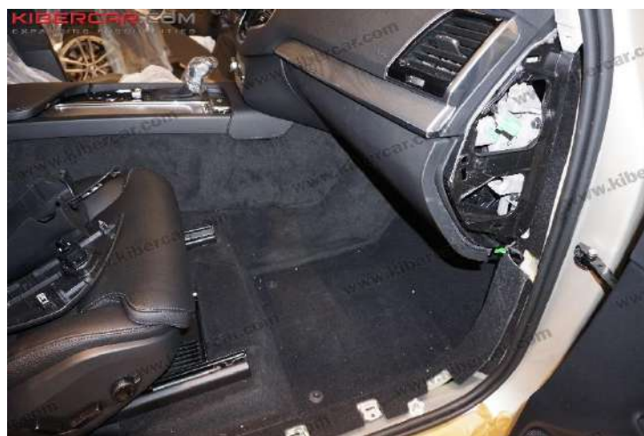
Рисунок 18 – Демонтаж боковых накладок
