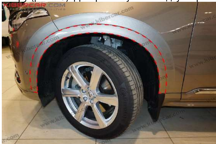
Рисунок 25 – Демонтаж накладки с передней арки
