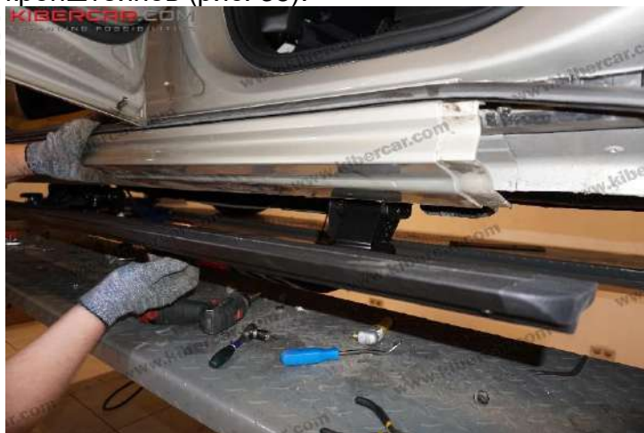
Рисунок 35 – Установка защитного кожуха
